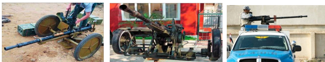
14,5-мм пулемет ПКП – пулемет Владимирова (выпуска после 1956 г.) на колесном полевом станке. Оптический прицел установлен на станок позже. 14,5-мм зенитная пулеметная установка ЗПУ-1 (без сиденья наводчика и патронной коробки) в экспозиции военного музея Вьетнама.; КПВ в Ираке
